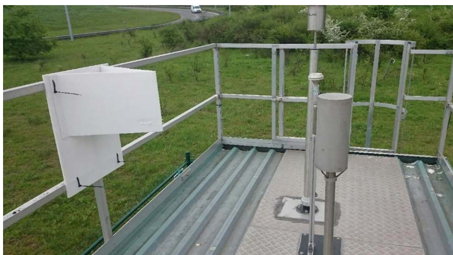
Figuur 5: Een meetbord bevestigd aan een VMM-meetstation.
